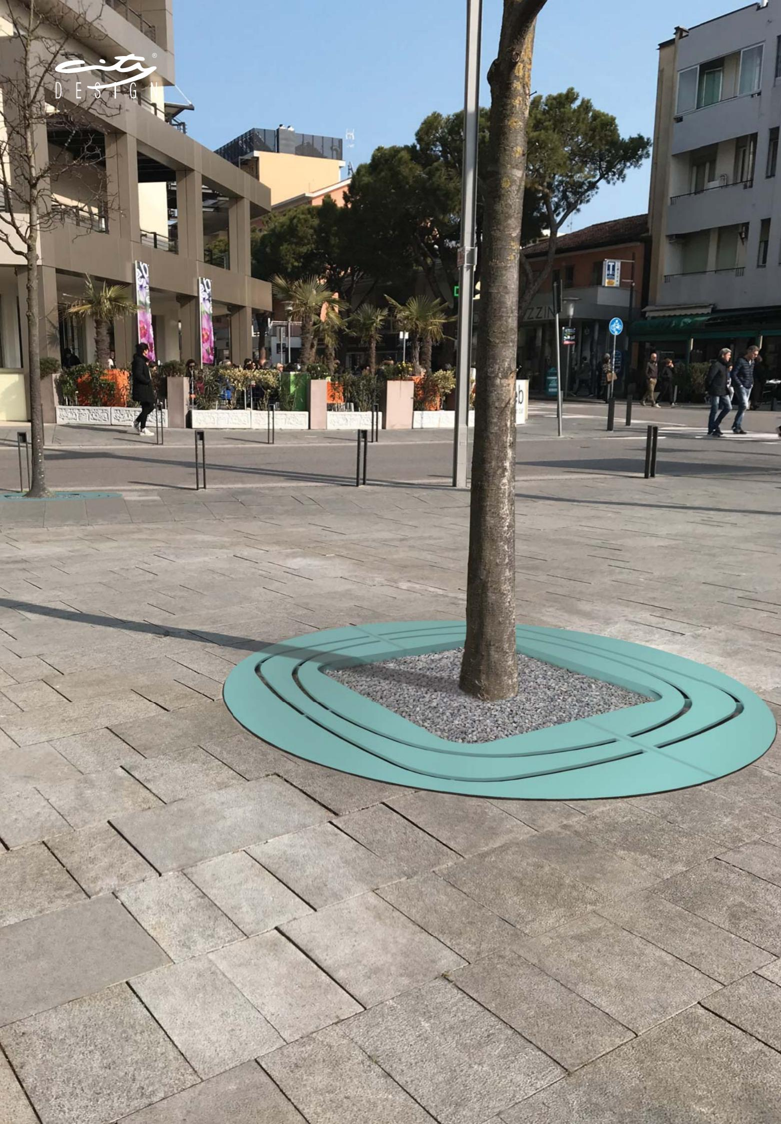
Griglia salvapiante realizzata in lamiera d'acciaio, decorata e sagomata con idonei rinforzi. Viene proposta in tre versioni circolari, di varie misure, in acciaio zincato e verniciato oppure in acciaio inox. Per ogni versione si può richiedere il relativo controtelaio in acciaio in profilo ad "L" con staffe per la cementazione.
