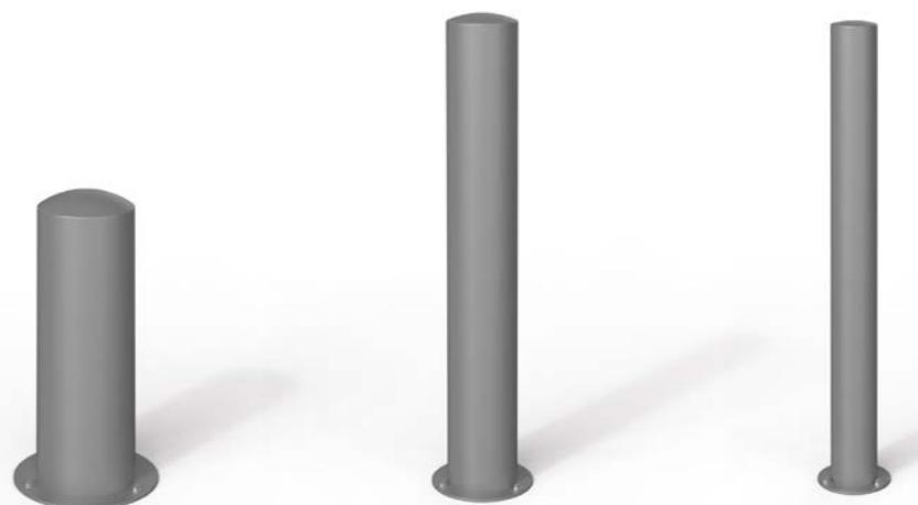
Borne piétonne en acier tubulaire galvanisé, disponible en trois tailles (D=102, D=152 ou D=219 mm), avec un élément terminal en tôle d'acier incurvée.
