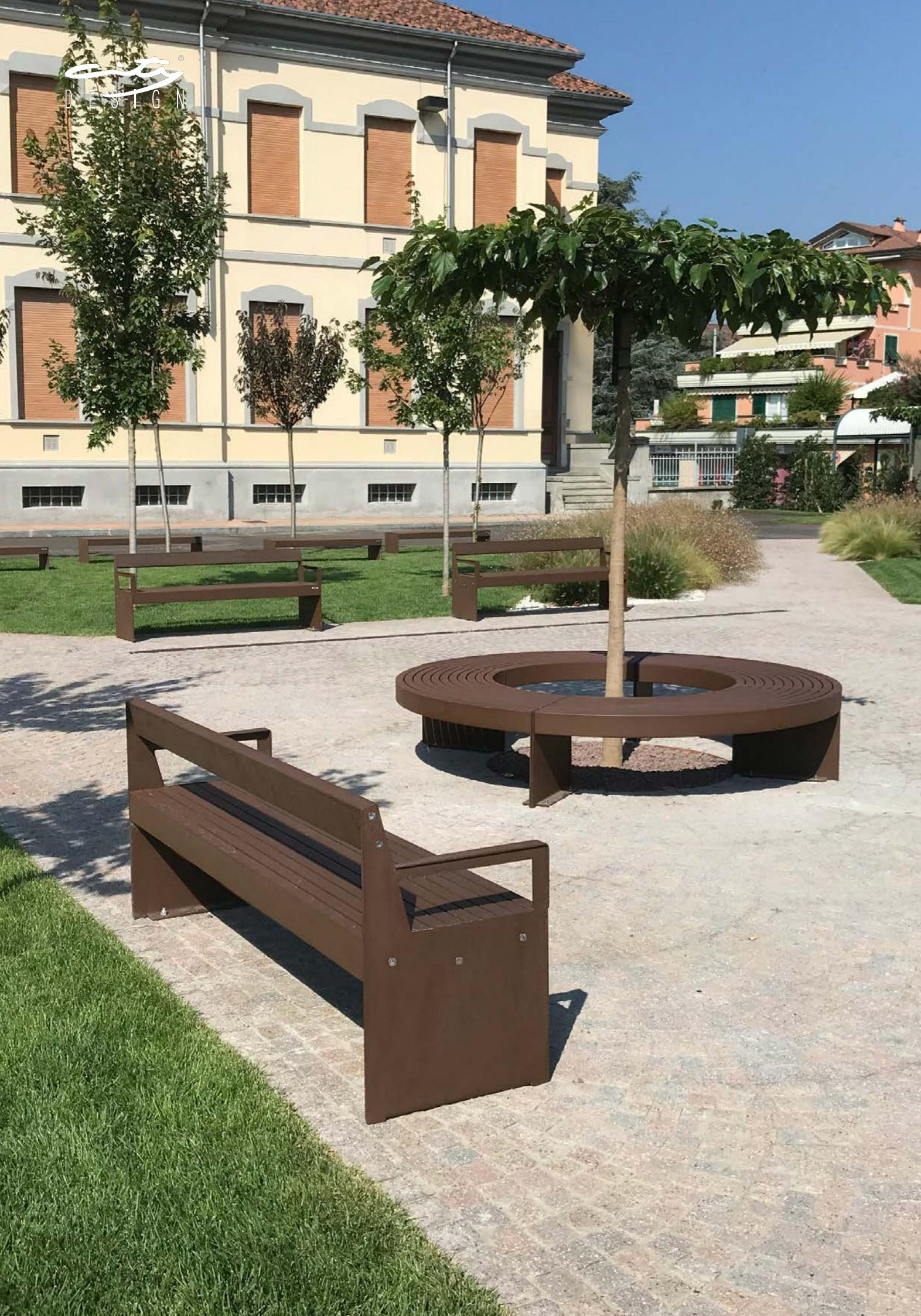
Panca con schienale e braccioli composta da due spalle in lamiera d'acciaio, con seduta in listoni di legno duro o pino termo-trattato o doghe in WPC, su di un telaio in tubolari d'acciaio e centine in lamiera piegata. Disponibile anche una versione con piano di seduta in tubolari d'acciaio. Tutte le parti metalliche sono zincate e vernicate a polvere poliestere. Tutta la viteria è in acciaio inox AISI304. Predisposizione con fori per il fissaggio a terra con tasselli meccanici (non inclusi).
