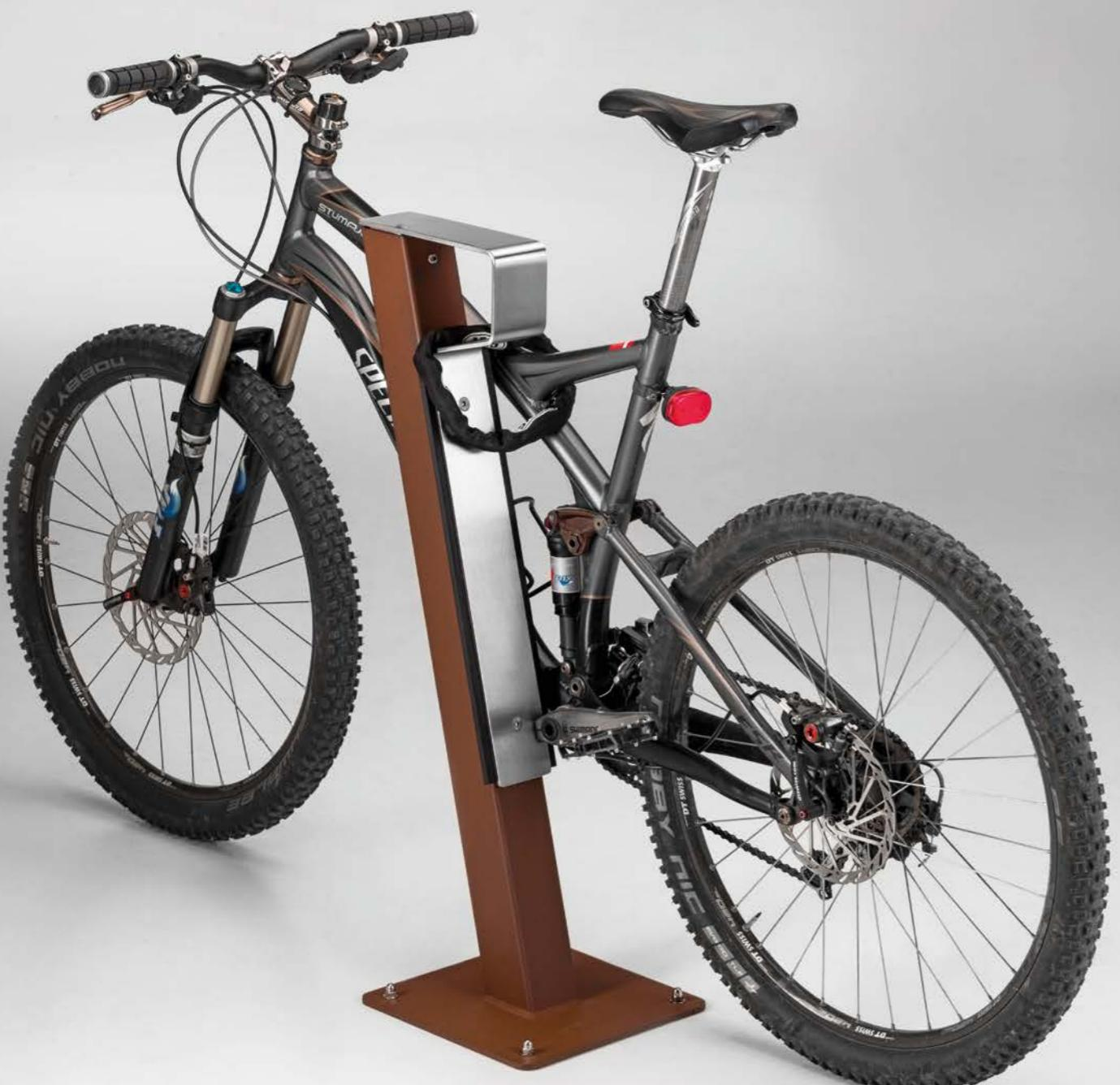
Portabiciclette costituito da un supporto inclinato in tubolare di acciaio con piastra base su cui si fissa meccanicamente il profilo reggi-ruota in lamiera sagomata d'acciaio, disponibile nella versione inox o zincato e verniciato a polvere di poliestere.
