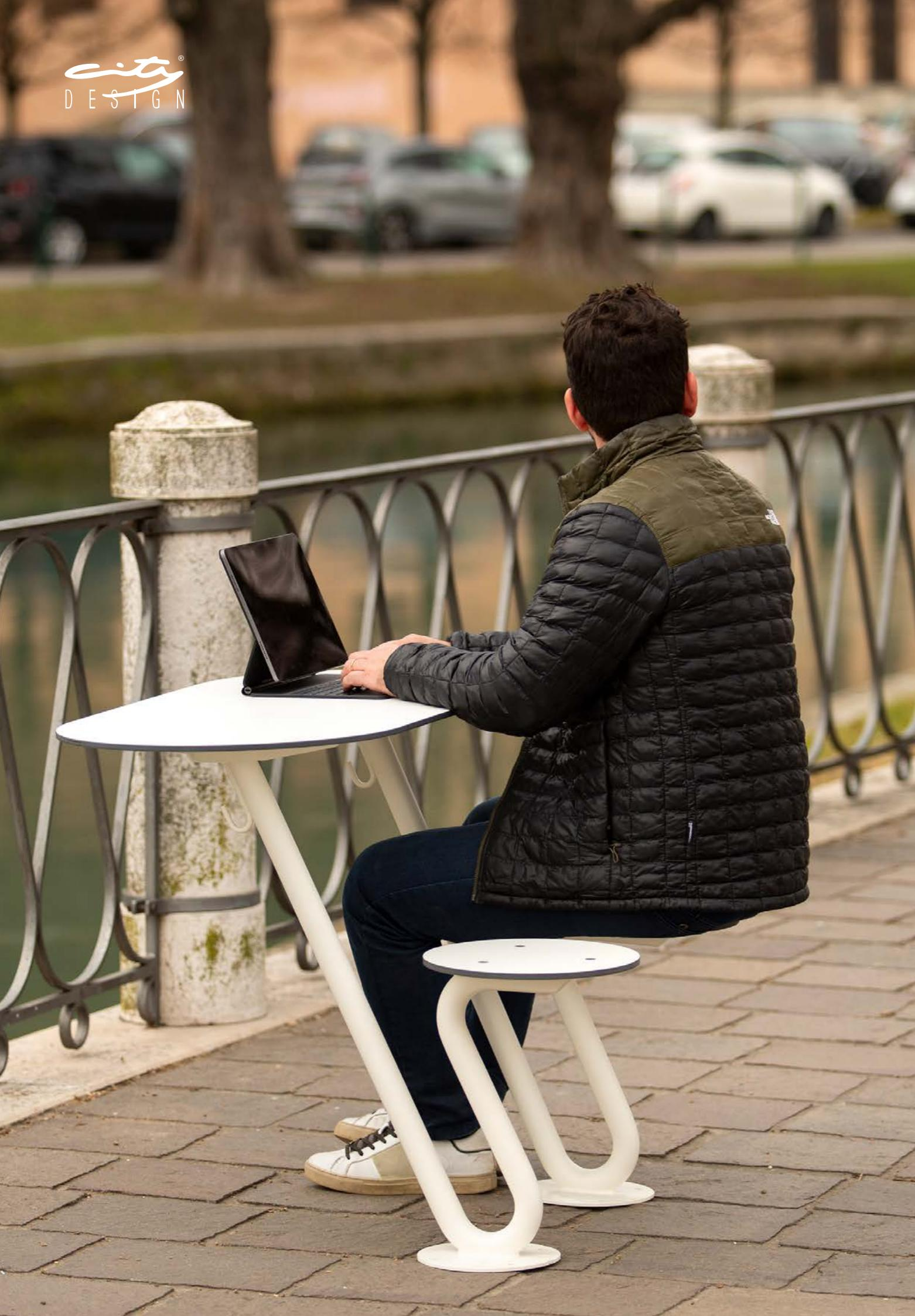
Collezione di tavoli con sedute integrate di forma circolare o ovale realizzati da uno o due supporti in tubolare tondo curvato su cui sono fissate le sedute e il piano ovale o circolare, entrambi realizzati in HPL. Tutte le parti metalliche sono zincate e vernicate a polvere poliestere termoindurente. Tutta la viteria è in acciaio inox AISI304. Predisposizione con fori per il fissaggio a terra con tasselli meccanici (non inclusi).
