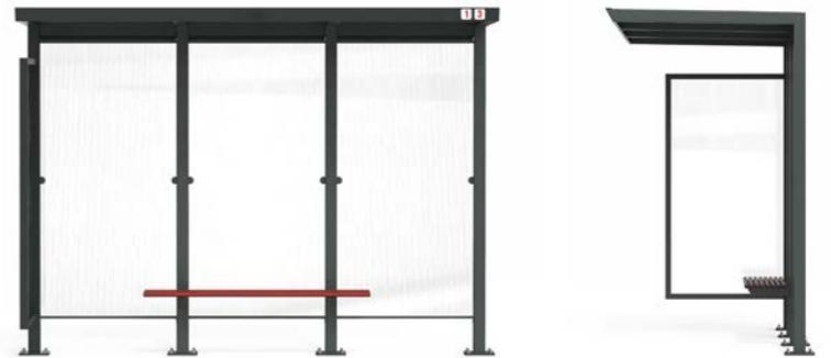
Abris composé d'une série de colonnes en porte-à-faux en tube carré d'acier avec une platine de base en tôle d'acier surmontée d'une couverture en tôle. Les parois de fond sont disponibles en verre ou polycarbonate alvéolaire tandis que l'assise est en tube d'acier.
