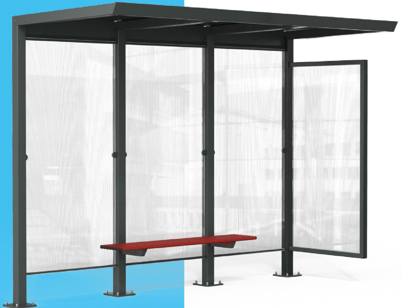
Pensilina composta da una serie di colonne a sbalzo realizzate in tubo quadro di acciaio con piastra base in lamiera di acciaio sormontata da una copertura in lamiera.
