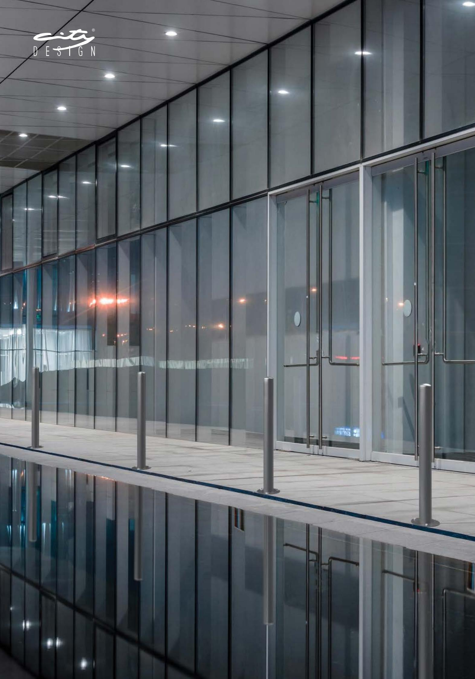
Dissuasore in acciaio inox spazzolato costituito da tubolare D=60 mm oppure D=90mm con terminale bombato in lamiera di acciaio inox.
