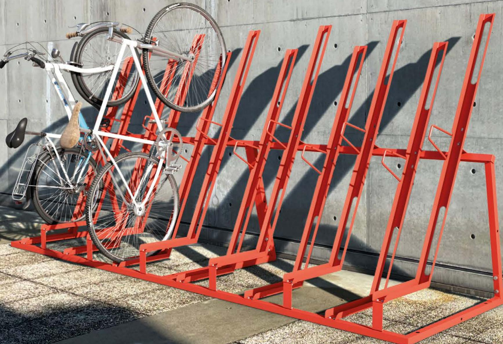
Portabici verticale modulare composto da una struttura portante a V in tubolare quadro di acciaio su cui sono fissati alternativamente tre stalli bassi e tre stalli alti. Questi ultimi sono realizzati in lamiera di acciaio. Tutte le parti metalliche sono zincate e vernicate a polvere poliestere termoindurente.
