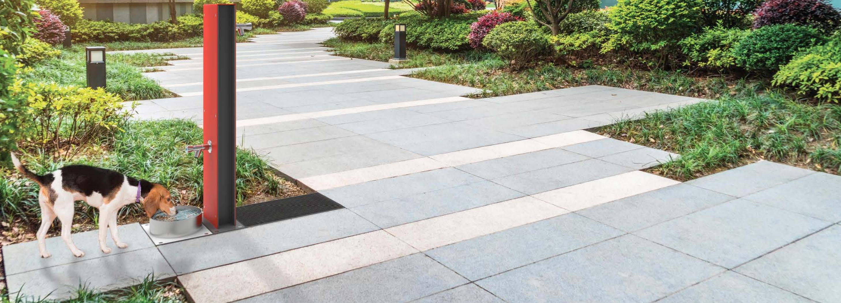
Fontana con struttura portante in profilo a C di lamiera di acciaio e pannelli di tamponamento fissati meccanicamente alla struttura.
