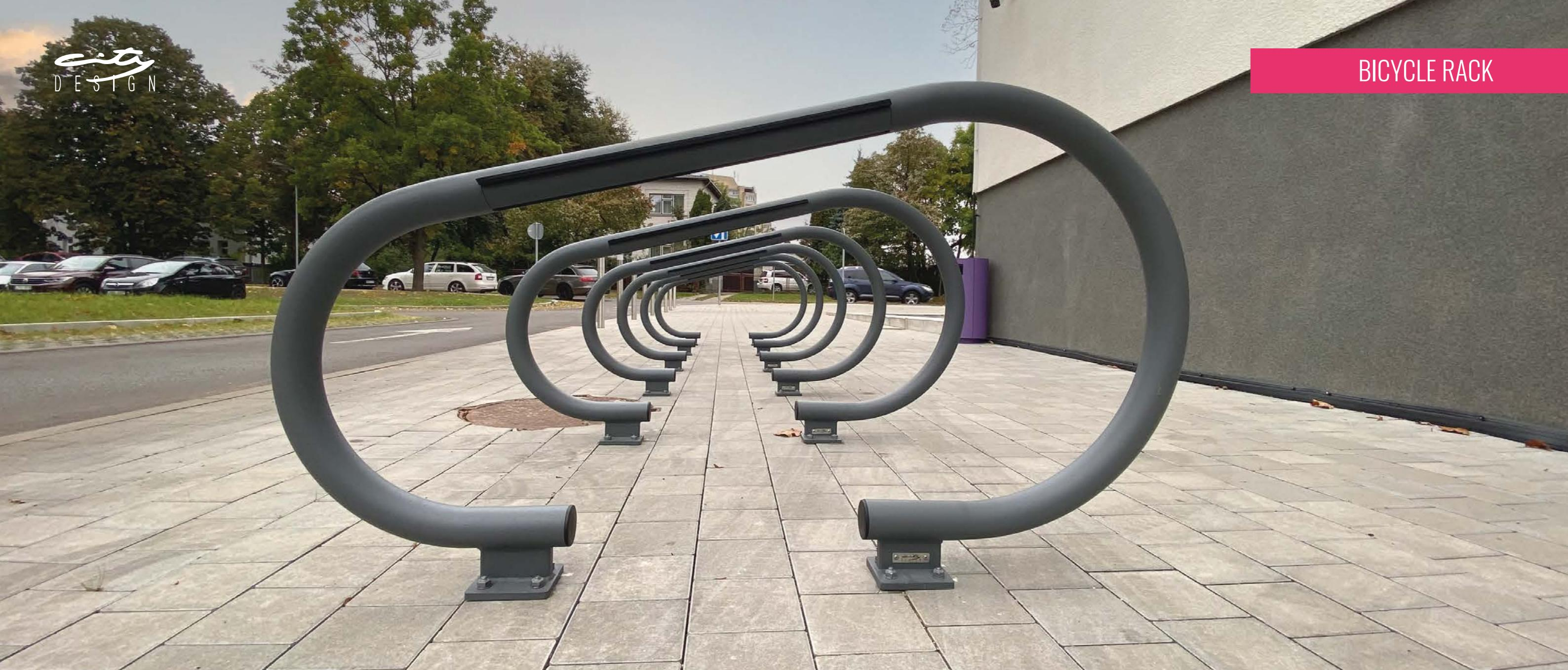
Portabici ottenuto dalla piegatura e lavorazione laser di un unico tubolare in acciaio. La parte centrale del tubo è tagliata in modo da ospitare un particolare profilo estruso di alluminio verniciato che funge da supporto per la fascia di protezione per la bicicletta, in EPDM.
