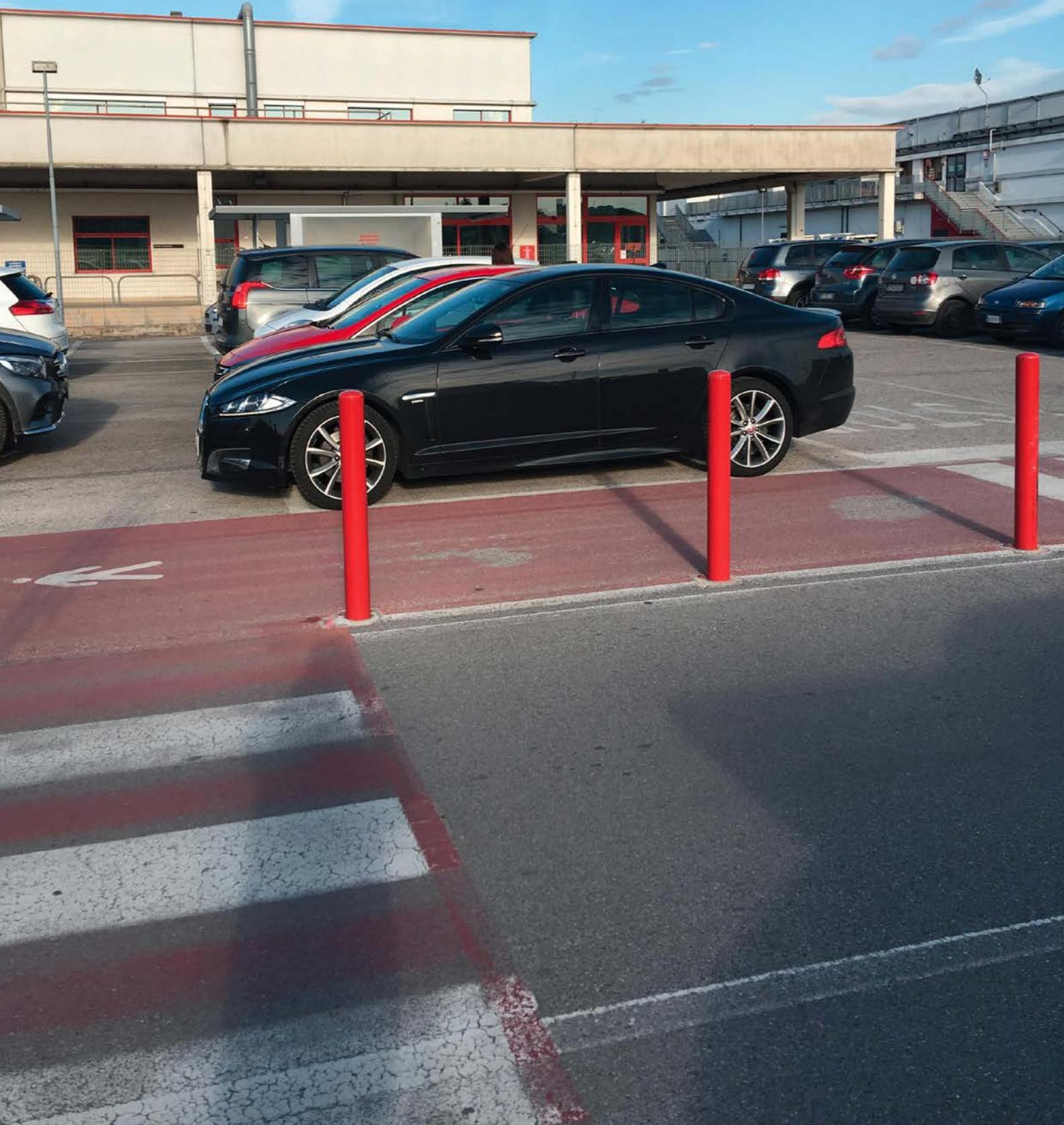
Dissuasore pedonale realizzato in tubolare di acciaio zincato in tre misure (D=102, 152 o 219 mm) con elemento terminale bombato in lamiera d'acciaio.
