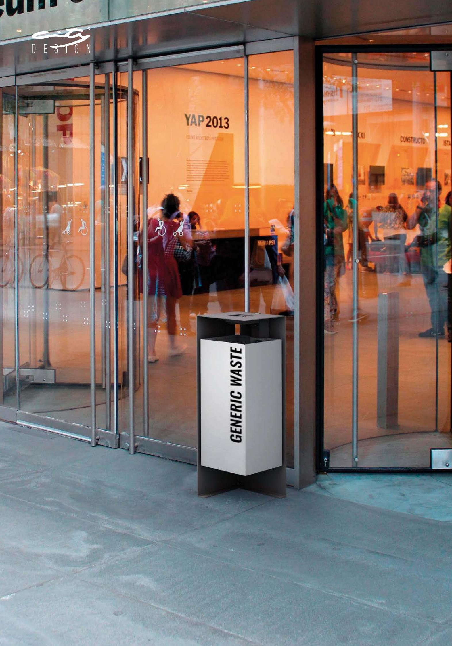
Cestino portarifiuti in lamiera d'acciaio con copertura integrata, dotato di contenitore basculante con chiusura a scatto. Il contenitore, in lamiera d'acciaio è proposto nella versione in lamiera cieca o stirata ed è dotato di anello reggisacco in tondo d'acciaio.
