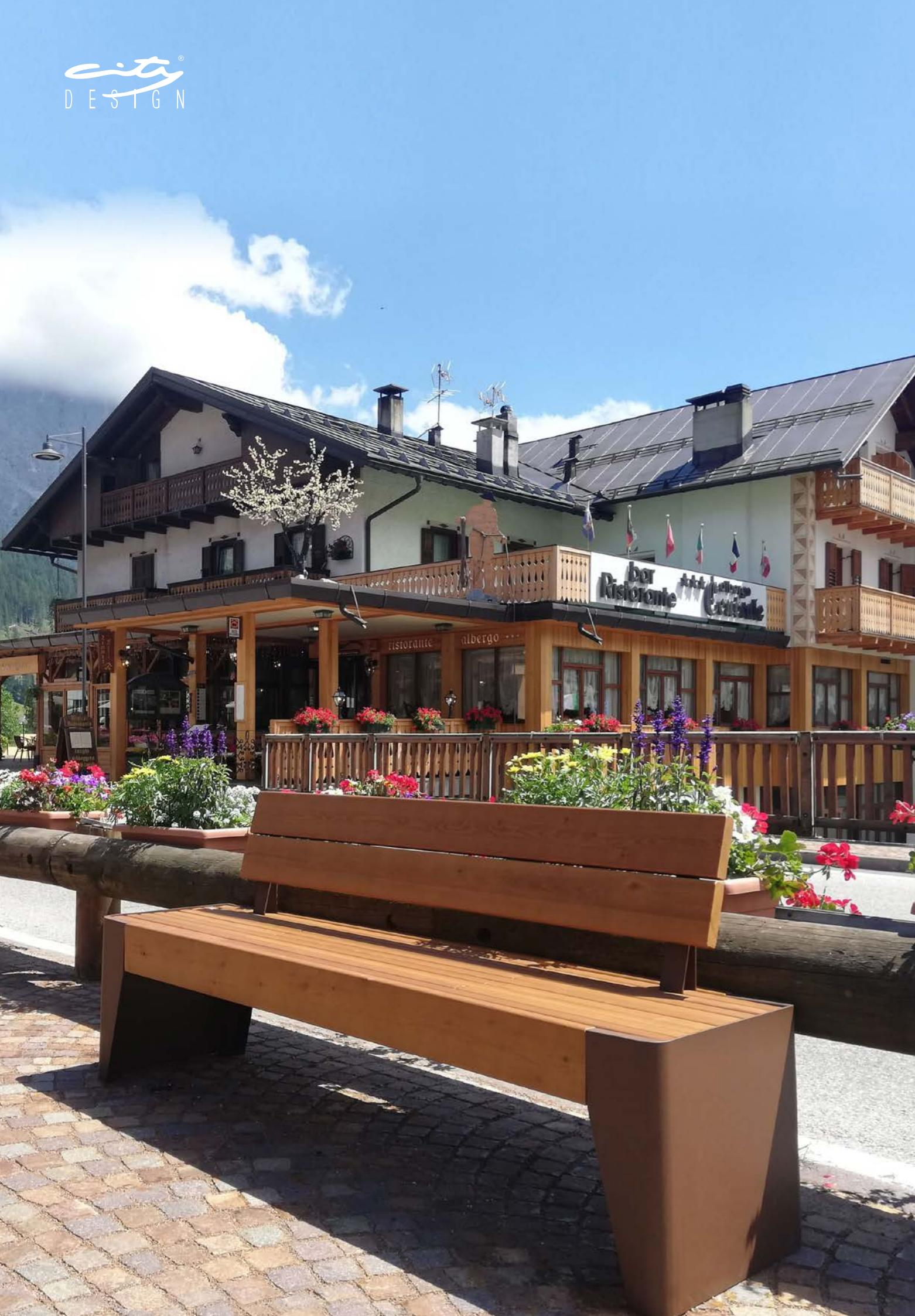
Panca composta da due spalle in lamiera d'acciaio con seduta composta da listoni di legno duro o pino termo-trattato su di un telaio in tubolare d'acciaio e centine in lamiera piegata.
