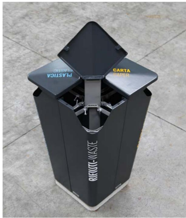
Cestino quadripartito per la raccolta differenziata, con basamento in cls, supporto centrale in tubo quadrato, struttura esterna troncoconica in lamiera d'acciaio e coperchi indipendenti apribili in fusione di alluminio.
