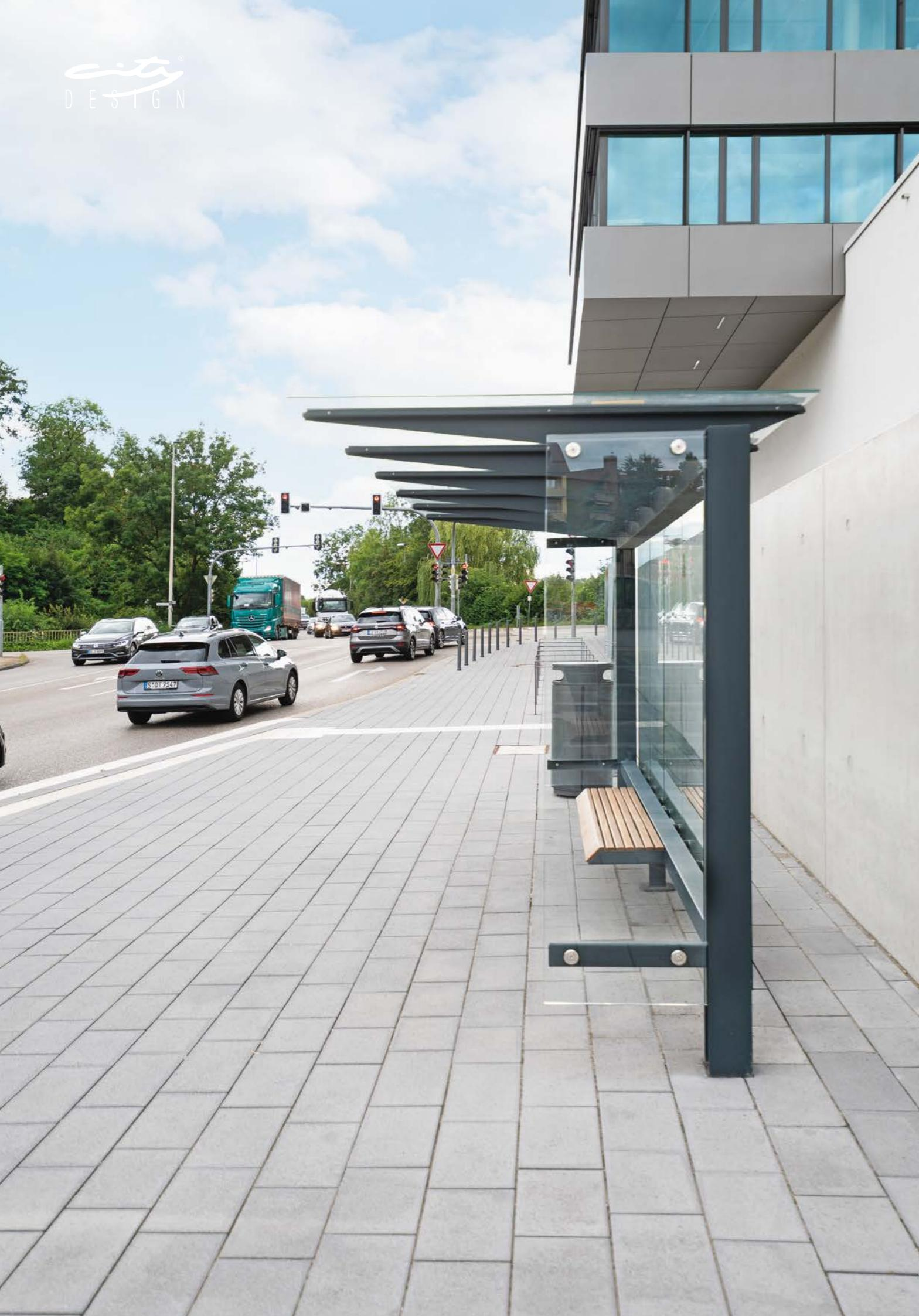
Pensilina modulare, disponibile a tre, quattro o cinque moduli con due diverse profondità, costituita da una struttura in travi HEB con piastre base in lamiera di acciaio, copertura piana in vetro temperato stratificato e pareti in vetro temperato.
