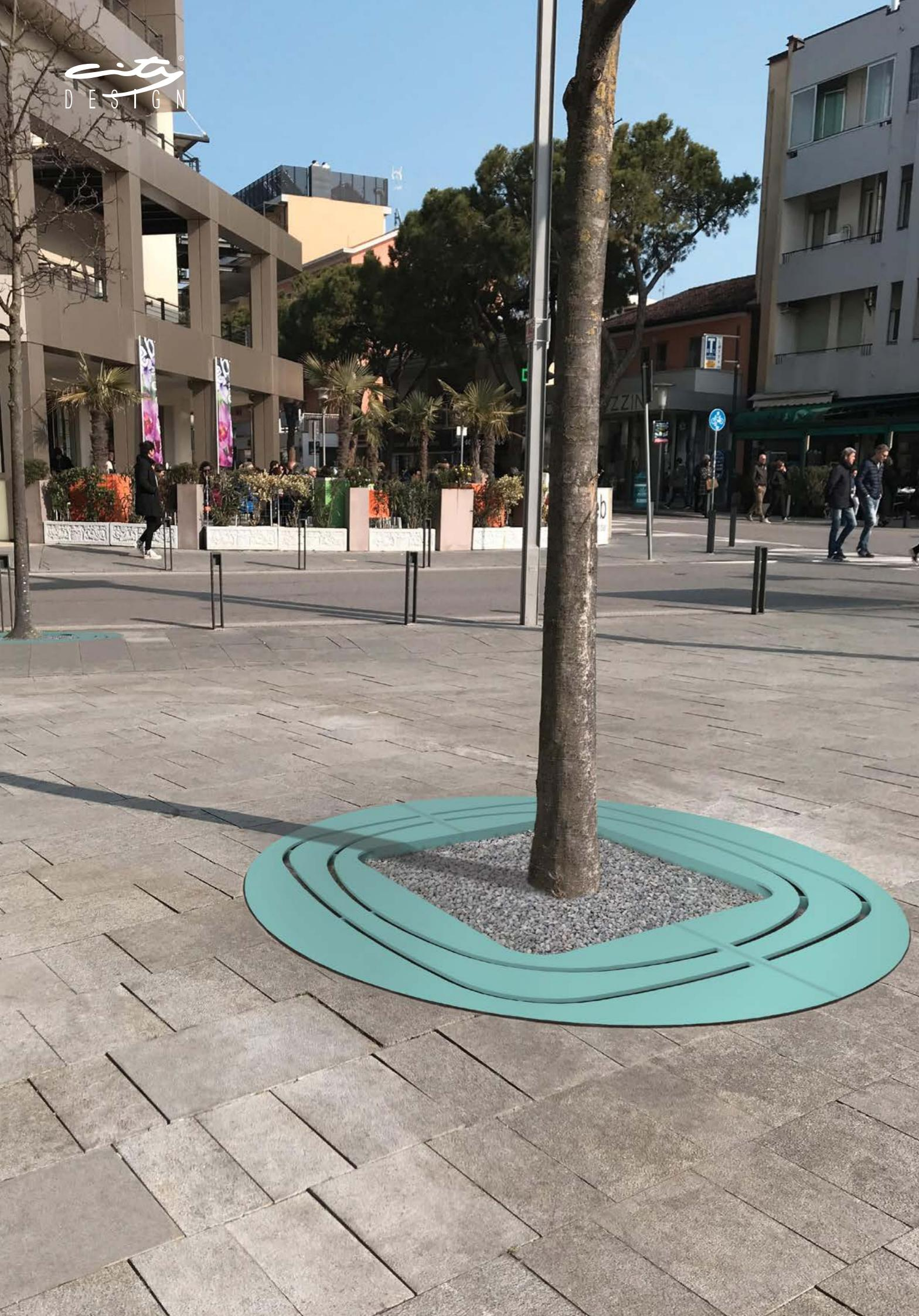
Griglia salvapiante di forma circolare con foro quadrato, disponibile in tre misure, realizzata in lamiera di acciaio con decori. Per ogni versione è disponibile il relativo controtelaio zincato in profilo d'acciaio ad "L" con staffe per la cementazione. Tutte le parti metalliche sono zincate e verniciate a polvere poliestere termoindurente, ad eccezione del controtelaio. Tutta la viteria è in acciaio inox AISI304. Fissaggio a terra con cementazione del controtelaio e griglia in appoggio.
