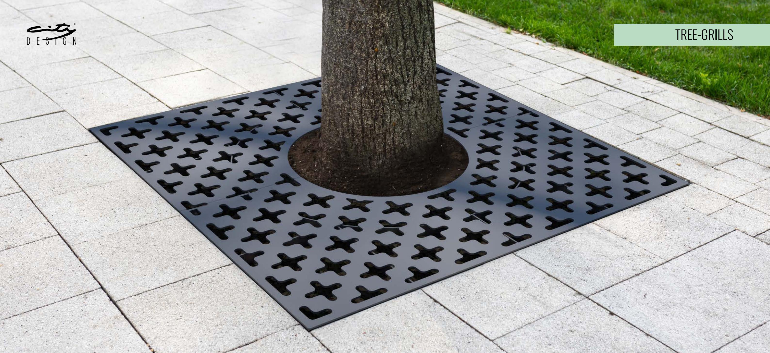
Griglia salvapiante di forma quadrata, disponibile in tre misure, realizzata in lamiera di acciaio con decori a crocette. Per ogni versione è disponibile il relativo controtelaio zincato in profilo d'acciaio ad "L" con staffe per la cementazione. Tutte le parti metalliche sono zionate e verniciate a polvere poliestere termoindurente, ad eccezione del controtelaio.
