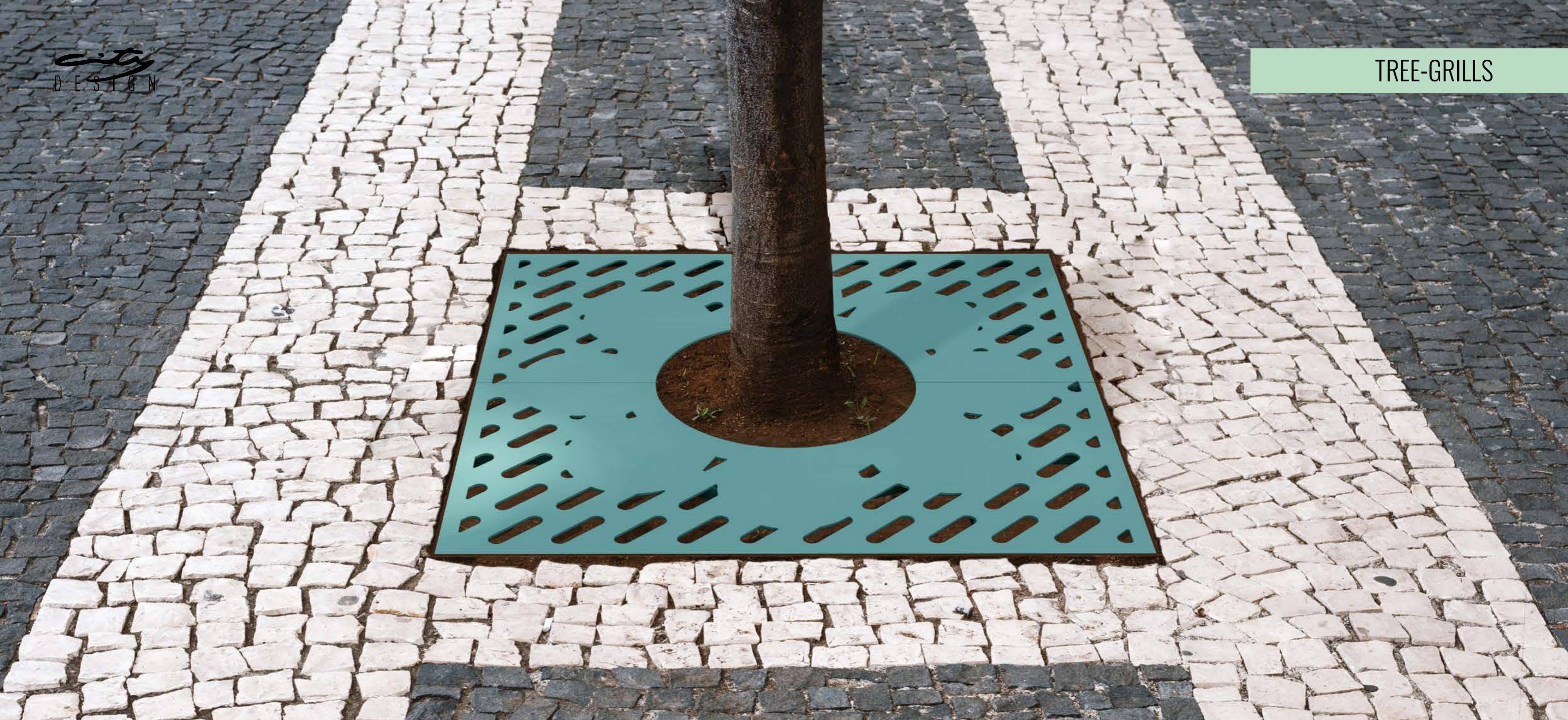
Griglia salvapiante di forma quadrata, disponibile in tre misure, realizzata in lamiera di acciaio con decori a linee tratteggiate. Per ogni versione è disponibile il relativo controtelaio zincato in profilo d'acciaio ad "L" con staffe per la cementazione.
