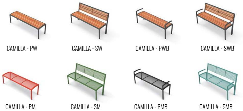
Banc sans ou avec dossier ou avec dossier en tube d'acier calandré et soudé, avec ou sans accoudoir. L'assise et le dossier sont composés d'un cadre en tube et rond d'acier ou de lames en bois dur. Toutes les parties métalliques sont galvanisées et thermolaquées en poudre de polyester thermodurcissable. Toute la visserie est en acier inoxydable AISI304. Prédisposition pour la fixation au sol au moyen de barres filetées à sceller (incluses).
