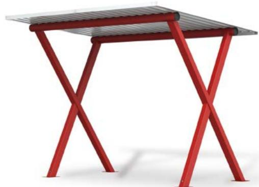
Cubierta para bicicletas formada por montantes en forma de X de acero tubular rectangular. Los montantes están unidos por dos travesaños horizontales en tubo de acero redondo sobre los que se fijan los paneles de chapa trapezoidal que sirven de cubierta.
