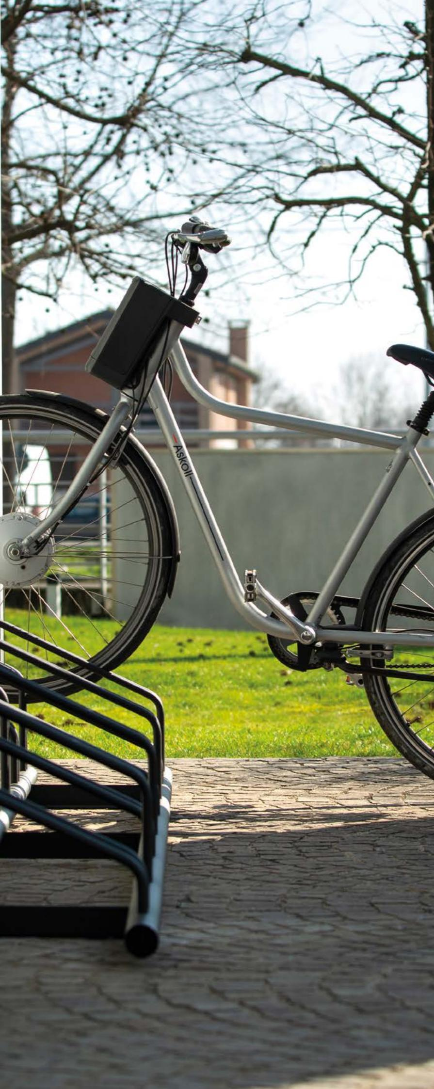
Collezione di portabici a due livelli modulare realizzati da due orizzontali di base in tubolare tondo di acciaio su cui sono saldati alternativamente stalli bassi e stalli alti. Questi ultimi sono composti da una coppia di tubolari tondi in acciaio. Disponibile nella versione da quattro, sei o otto posti. Tutte le parti metalliche sono zincate e vernicate a polvere poliestere termoindurente. Predisposizione con fori per il fissaggio a terra con tasselli meccanici (non inclusi).
