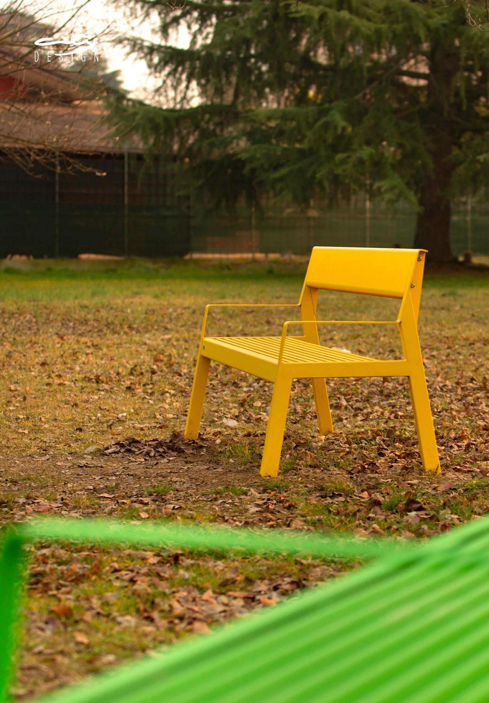
Panca piana o con schienale, con o senza braccioli costituita da due supporti in tubolare di acciaio e seduta con telaio in lamiera piegata e tubolari in acciaio. Lo schienale e il bracciolo sono in acciaio piegato. Tutte le parti metalliche sono zincate e vernicate a polvere poliestere termoindurente. Tutta la viteria è in acciaio inox AISI304. Predisposizione per il fissaggio a terra tramite barre filettate a cementare (incluse).
