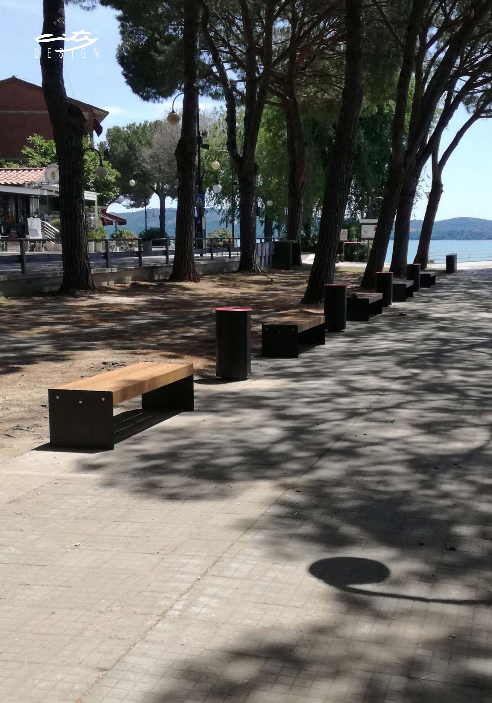
Panca piana composta da due spalle in lamiera d'acciaio, con seduta in listoni di legno duro o pino termo-trattato o doghe in WPC, su di un telaio in tubolari d'acciaio e centine in lamiera piegata. Disponibile anche una versione con piano di seduta in tubolari d'acciaio. Tutte le parti metalliche sono zincate e verniciate a polvere poliestere. Tutta la viteria è in acciaio inox AISI304. Predisposizione con fori per il fissaggio a terra con tasselli meccanici (non inclusi).
