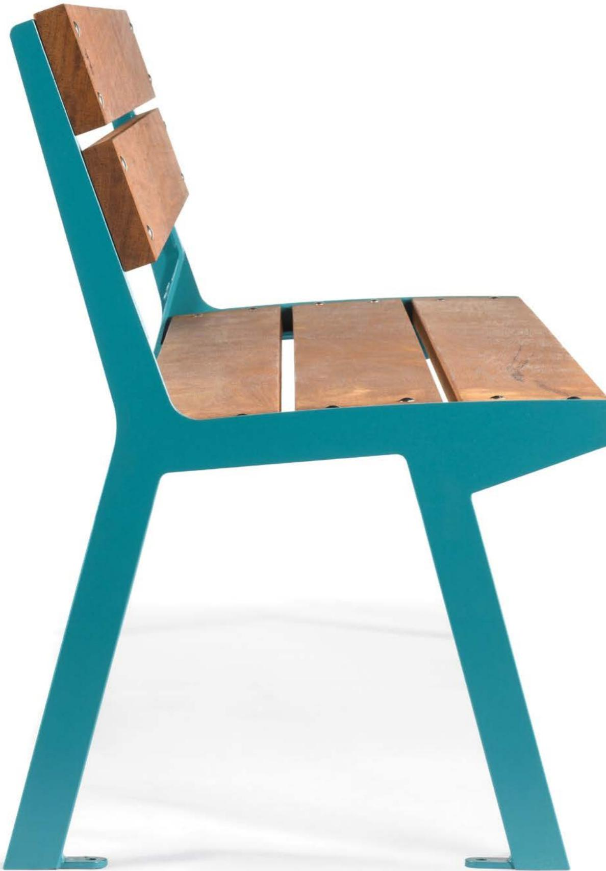
Panca piana o con schienale con o senza bracciolo, costituita da supporti e spalle in acciaio per il fissaggio della seduta. La seduta è realizzata con tre listoni mentre lo schienale con due listoni, entrambi di legno duro o pino termo-trattato. Tutte le parti metalliche sono zincate e verniciate a polvere poliestere. Tutta la viteria è in acciaio inox AISI304. Predisposizione con fori per il fissaggio a terra con tasselli meccanici (non inclusi).
