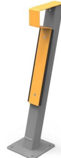
Porte-vélos composé d'un support tubulaire incliné en acier avec une platine de base sur laquelle est fixé mécaniquement le profilé de maintien des roues en tôle d'acier façonnée, disponible en acier inoxydable ou galvanisé et thermolaqué en poudre de polyester.
